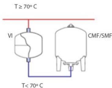
En sistemas de refrigeración con temperaturas por debajo de 0°C, es recomendable colocar un vaso intermedio en línea con el vaso de expansión.
