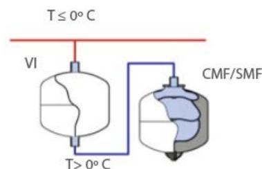
En sistemas solares es recomendable colocar un vaso intermedio en línea con el vaso de expansión.
