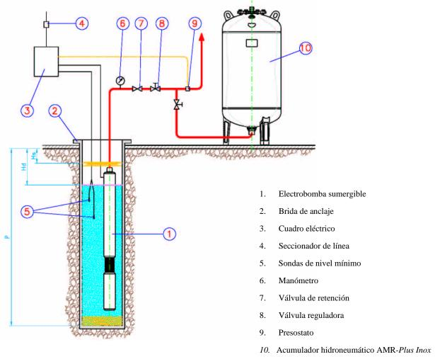
Hs Nivel estático Hd Nivel dinámico P Profundidad del pozo
