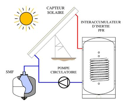
Ne conviennent pas pour l'utilisation dans des circuits ouverts avec de l'eau potable, des hydrocarbures et des fluides appartenant au groupe 1 conformément à la directive 2014/68/UE. La teneur en glycol de l'eau ne doit pas dépasser le 5%0. Les réservoirs mentionnés dans le présent document ne sont pas aptes à être placés à l'extérieur.
