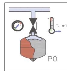
Se recomienda mantener constante la presión de la acometida de la red instalando un reductor de presión.
