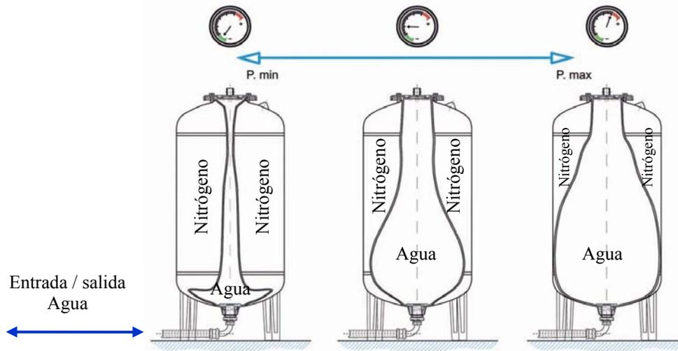
Cuando se alcanza la presión máxima deseada (presión de paro bomba), el presostato corta la corriente y se interrumpe en este instante la circulación de agua entre la bomba y el depósito. En este momento existirá un volumen de agua almacenado en el interior del depósito a una presión igual a la presión de paro de la bomba.
